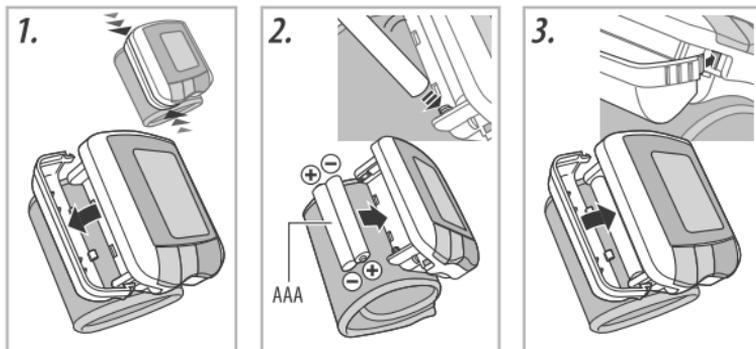
1 Отсоедините крышку отсека для элементов питания. Не прилагайте чрезмерных усилий при снятии крышки.
