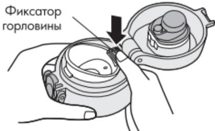
1. Для того, чтобы разобрать крышку-пробку, нажмите на фиксатор горловины по направлению к центру как показано на рисунке – горловина автоматически выпадет вниз.
