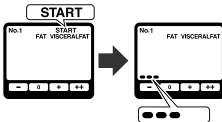
Ход выполнения измерения отображается в нижней части дисплея индикаторами, полоса которых движется слева направо.
