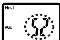
3. С помощью кнопки ▲ или ▼ измените выбранное значение, затем нажмите кнопку SET/MODE. На дисплее последовательно отобразятся возраст, пол и рост.
