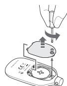
2 Выньте батарею, используя тонкую, жесткую и прочную палочку.
