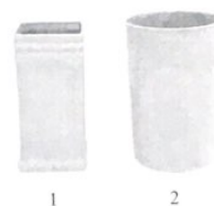
Рис. 2 - Стаканы керамические: 1. Стакан лабораторный керамический АГФТ 8.634.001 2. Стакан лабораторный керамический АГФТ 8.634.002
