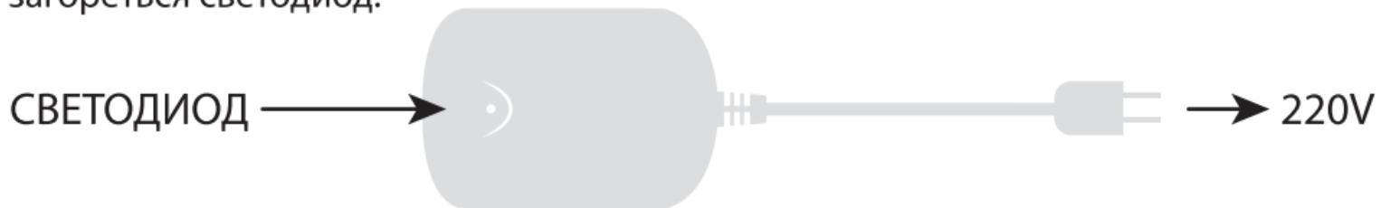
*Примечание - О наличии магнитного поля можно убедиться, наложив индикатор магнитного поля на рабочую поверхность излучателя.*
