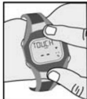
Оставьте палец прижатым к металлической поверхности корпуса на 3-7 секунд без перерыва. Во время измерения мигают пиктограмма сердца и оба горизонтальных штриха в центре.
