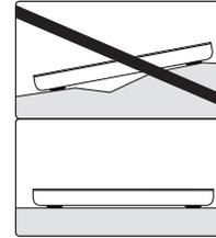
Установить весы на прочную ровную поверхность.
