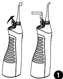
Откройте колпачок емкости для воды и, держа устройство в вертикальном положении, заполните емкость водой температуры не превышающей 40°C. Закройте колпачок и проверьте чтобы он был закрыт плотно.
