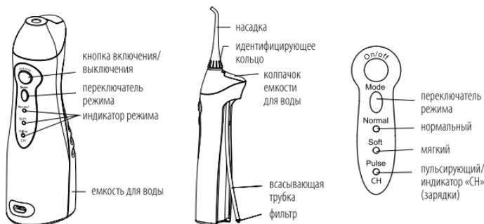
Для включения и выключения прибора нажмите кнопку «On/off». Нажмите на кнопку переключения режима «Mode» и выберите необходимый режим водяной струи (нормальный, мягкий, пульсирующий). Индикатор режима покажет ранее выбранный режим. Если хотите использовать другой режим, нажимайте на переключатель режима до тех пор, пока не будет достигнута необходимая настройка. Нажатие на переключатель режима будет изменять режим с нормального («Normal») на мягкий («Soft») и пульсирующий («Pulse»).
