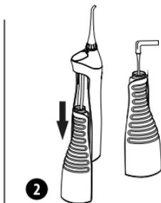
Снимите емкость для воды, держа прибор в вертикальном положении. Заполните емкость водой температуры не превышающей 40°C и вставьте емкость обратно в прибор.
