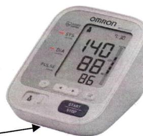
Место нанесения защитной наклейки от несанкционированного доступа
